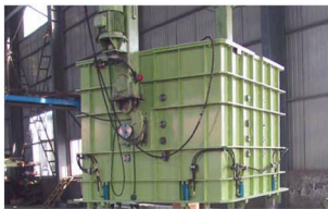
图8 芯模振动成型
